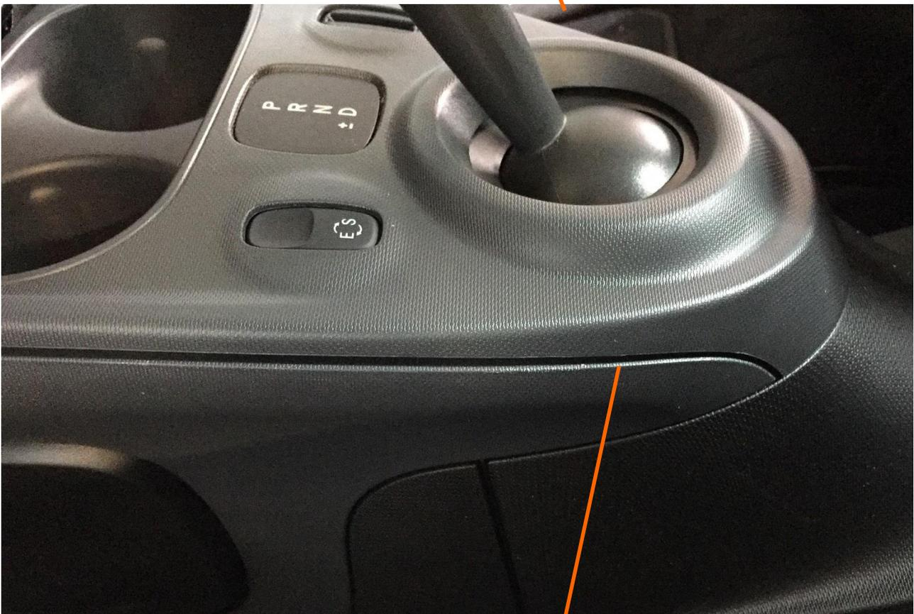
Setzen Sie auf beiden Seiten hier einen Kunststoffschaber oder ein anderes geeignete Werkzeug an um die Verkleidung an dieser Stelle nach oben abzuhebeln.
